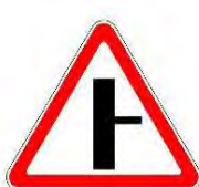
«Примыкание второстепенной дороги»
